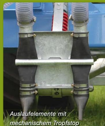
Auslaufelemente mit mechanischem Tropfstop
